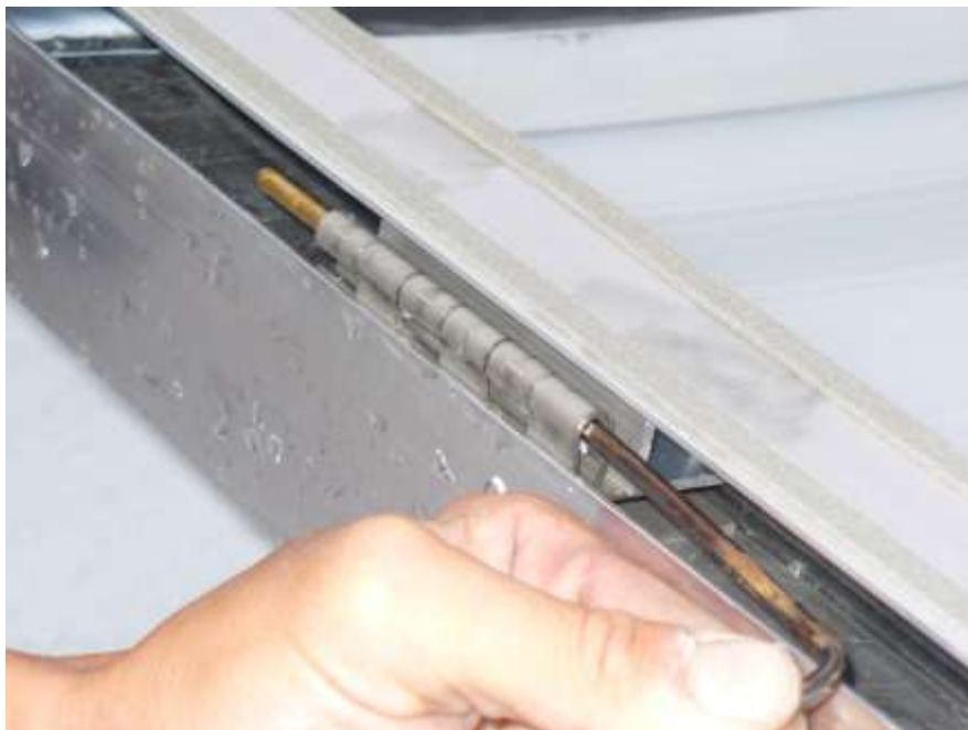
Abb.10 Man montiert die Scharniere ab
