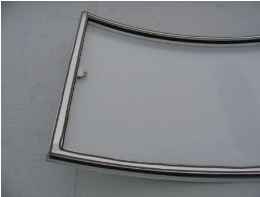
Abb.5 Die richtig angeklebte Doppeldichtung
